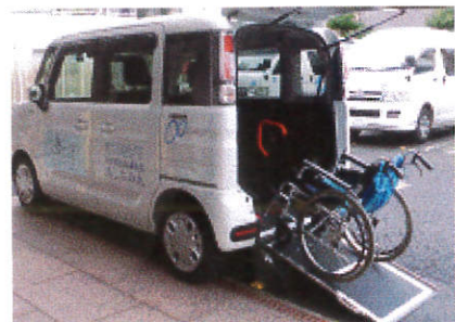
<車いすスロープ>
